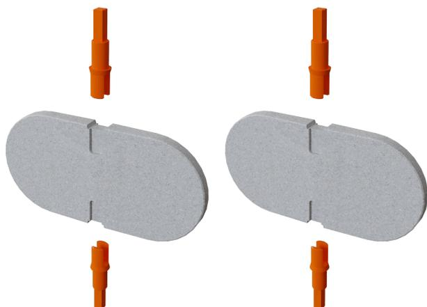
Commencez d'abord par insérer les axes en haut et en bas de chacun des 2 volets en PSE\*. *Nous recommandons d'exercer une légère pression sur les pinces pour un meilleur maintien sur le volet*
