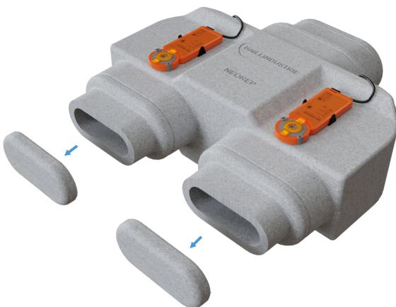
A l'aider d'un cutter, découpez les sorties en fonction du diamètre sélectionné
