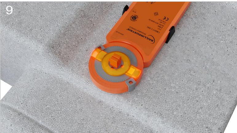
Clipez le servomoteur dans la pince noire. **ATTENTION** : le moteur s'installe avec le volet en position fermée, le repère sur l'axe du volet ainsi que l'aimant de débrayage indiquent l'orientation du volet à l'intérieur du plénum répartiteur
