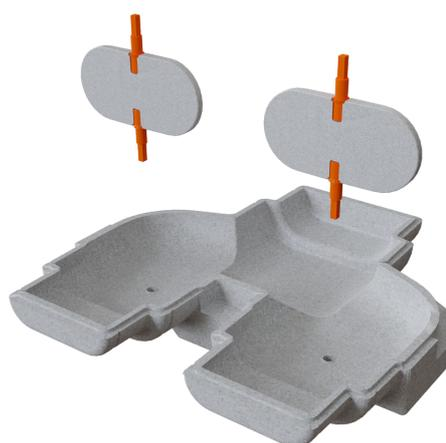
Insérez les volets dans les fentes de la partie basse du plénum répartiteur
