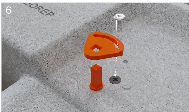
Dans le cas d'un volet manuel, vissez la/les cheville(s) nylon fournie(s) puis insérer le palier de guidage manuel et enfin la vis de serrage vous permettant de définir le débit nominal.
