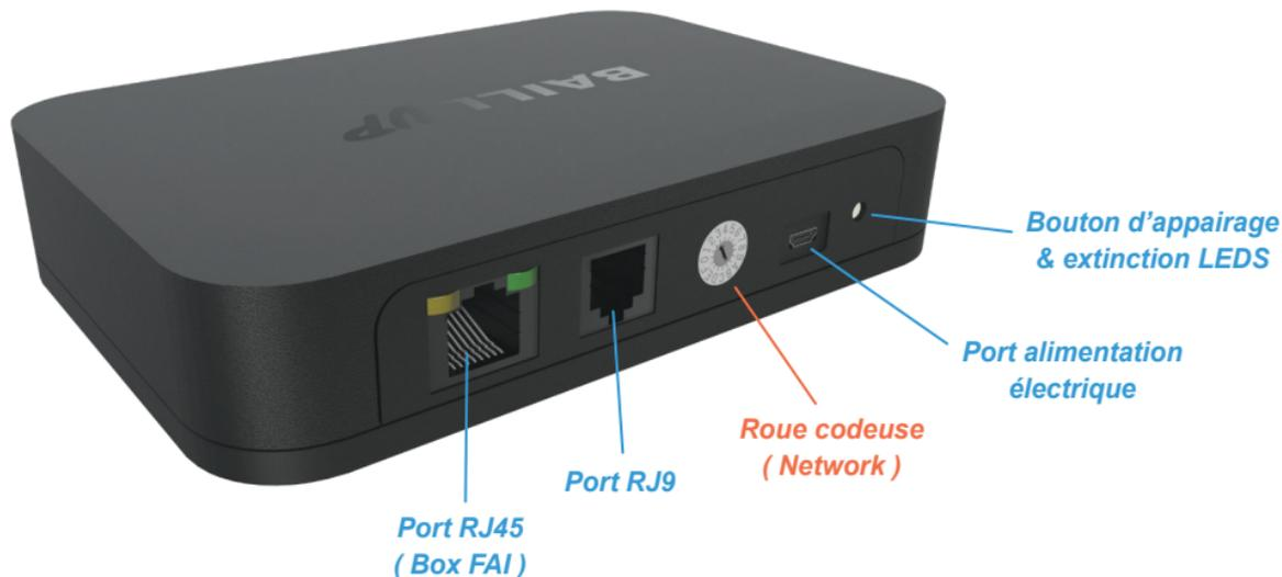
**NOTA :** La roue codeuse gère le NETWORK ( canal de communication radio ). Il correspond également à celui présent sur le boîtier d'unité centrale (UC) dans le coffret de régulation. *Le network de l'unité centrale est consultable directement depuis un des thermostats de la régulation.*
